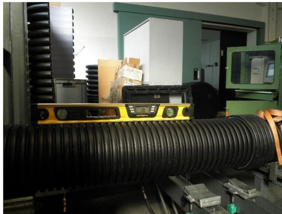
Fondamentali per la verifica della consistenza del flusso idraulico sono le prove di deformazione e tenuta idraulica per i tubi dotati di tenuta elastica con guarnizione, eseguite secondo la norma EN 1277.
